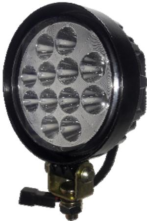
Utilizado sin la lente disipadora el LX301 libera toda su vasta potencia lumínica para obtener increíbles mediciones como 100 lux a 25 metros o 10 lux a 100 metros:
